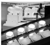
Dans l'industrie du ciment, l'analyse par fluorescence X (XRF) est l'une des principales techniques utilisées pour le contrôle de la qualité des matières premières et des produits finis. En règle générale, une préparation d'échantillon « par pastille » est utilisée ; Cependant, l'inconvénient est que cette technique ne montre que des données relatives aux méthodes de référence connues et acceptées et ne tient pas compte des différents effets minéralogiques qui peuvent ou non se produire.
